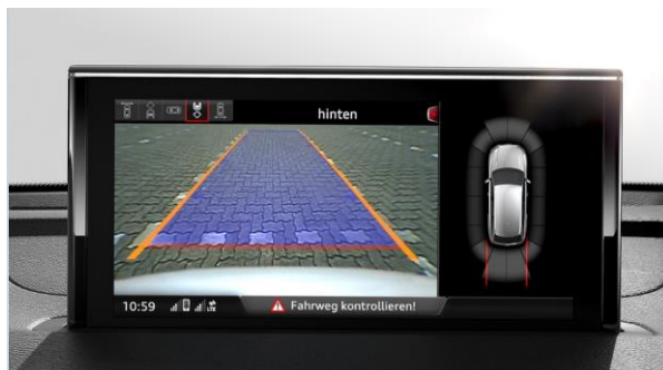
Sistema de aparcamiento plus delantero y trasero con cámara trasera
