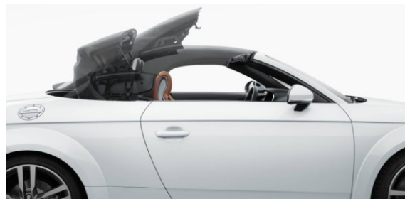
Capota de accionamiento eléctrico (tiempo de apertura: 10 seg.) Velocidad máxima de accionamiento: 50 km/hr
